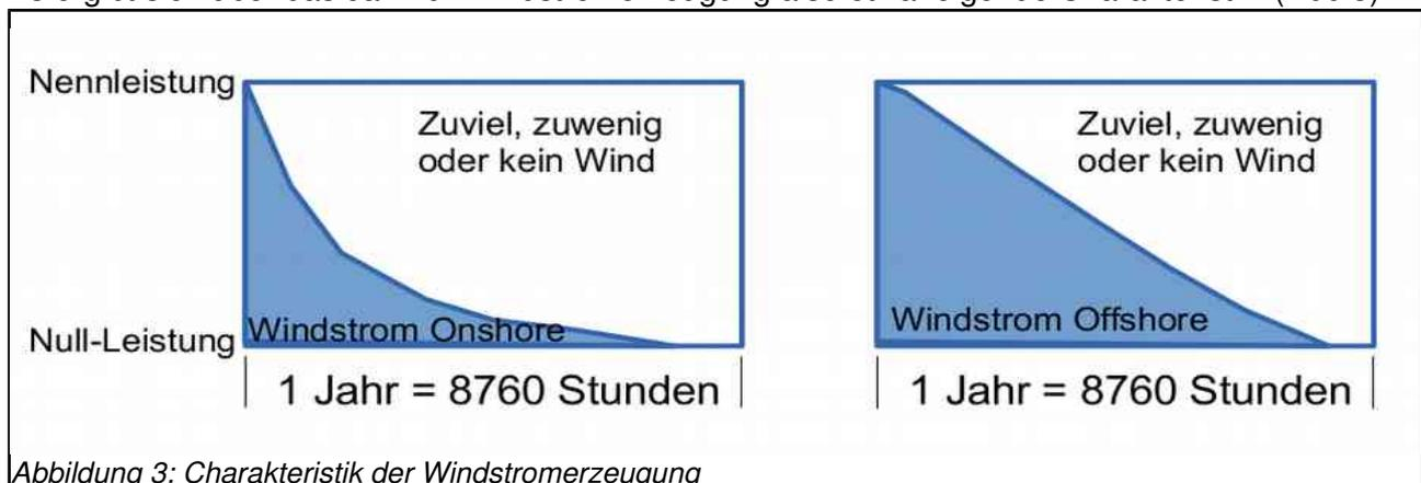
Abbildung 3: Charakteristik der Windstromerzeugung
